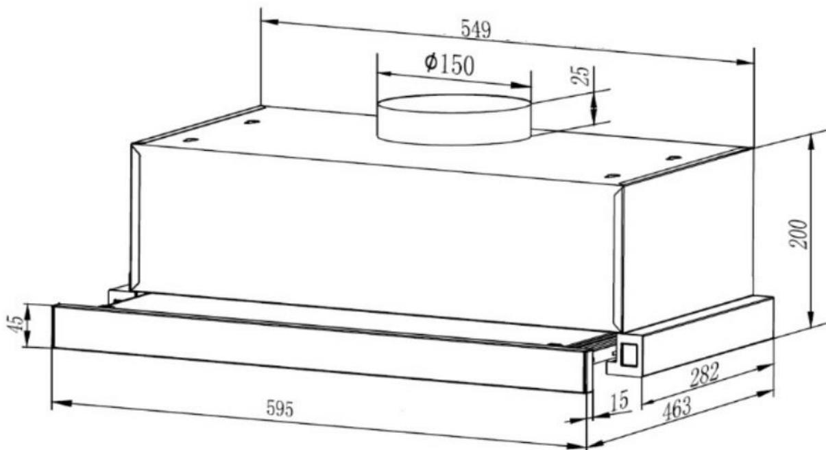
*Abbildung 1 Abmessungen*
