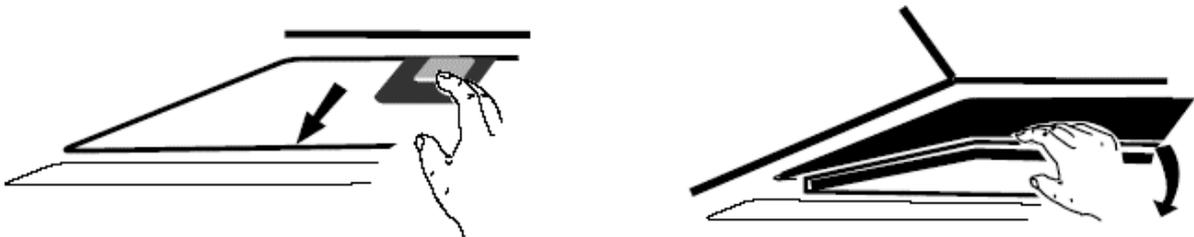
Abbildung 10 Aktivkohlefilterwechseln
