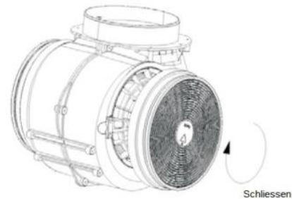
Abbildung 4 Aktivkohlefilter einsetzen
