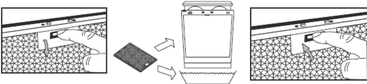
Abbildung 9 Filter reinigen
