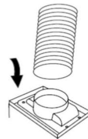
Abbildung 6 Abluftschlauch anschließen
