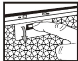
Abbildung 8 Haube reinigen
