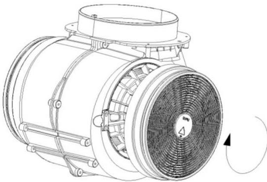
Abbildung 11 Aktivkohlefilterwechsel 2
