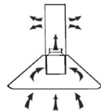
Der innere Kaminschacht dieser Dunstabzugshaube muss soweit über den äußeren Kaminschacht hinausragen, dass die gereinigte Luft ungehindert durch die Luftaustrittsöffnungen ausströmen kann.
