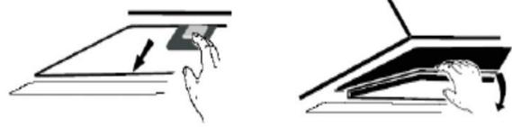
2. Die Aktivkohlefilter in beide Seiten einsetzen und drehen, bis sie einrasten (Abb. 8).
