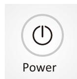
Wenn das Gerät angeschlossen ist und sich im Standby-Modus befindet, funktioniert die Taste "Power", um das Gerät einzuschalten. Nach dem zweiten Betätigen dieser Taste wechselt das Gerät in den Standby-Modus. (Das Symbol ist rot im Standby-Modus und grün im eingeschalteten Zustand.)
