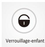
Lorsque l'appareil est allumée, appuyer sur le bouton «Verrouillage-enfant» pour verrouiller tous les boutons. À ce moment-là, tous les boutons n'ont aucune réaction à une touche, ainsi, l'appareil fonctionne toujours avec les paramètres définis auparavant. Appuyer sur le bouton « Verrouillage-enfant » pour 5 secondes puis l'appareil quittera ce mode. (Lorsque l'appareil fonctionne en mode de Verrouillage-enfant, l'icône restera allumé, sinon, l'icône sera éteinte.)
