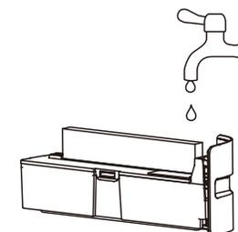
5. Füllen Sie ca. 1L kaltes Wasser durch den Einlass bis ca. 80% des Wassertanks.
