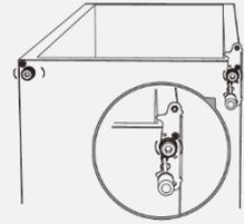
15. Stift vom unteren Scharnier lösen, das Scharnier um 180° drehen und Stift wieder einstecken.
