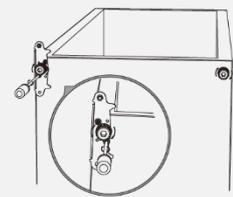
20. Stift des oberen Scharniers in die Vorrichtung der oberen Gerätetür einsetzen.
