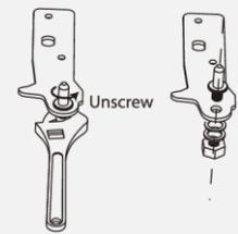
16. Unteres Scharnier mit zwei Schrauben links anschrauben.
