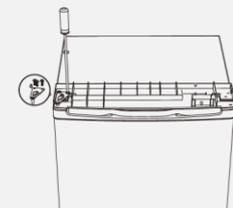
25. Abdeckplatte auflegen und hinten mit den beiden Schrauben befestigen.
