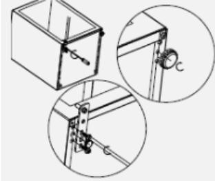
13. Stift des oberen Scharniers in das Loch der Gerätetür stecken.
