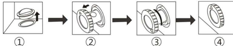
6. Zum Ablassen des Tauwassers einen Auffangbehälter unter den Tauwasserablauf (unten an der Gerätefront) stellen.
