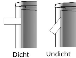
1. Eine Taschenlampe auf eine Glasablage im Gerät stellen, Lichtschein in Richtung der Gerätetürdichtung ausrichten und Tür schließen. Scheint kein direktes Licht durch, ist die Gerätetürdichtung dicht.
