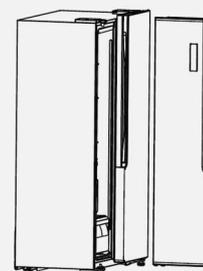
6. Gerät mit Hilfe einer weiteren Person etwas nach hinten kippen.
