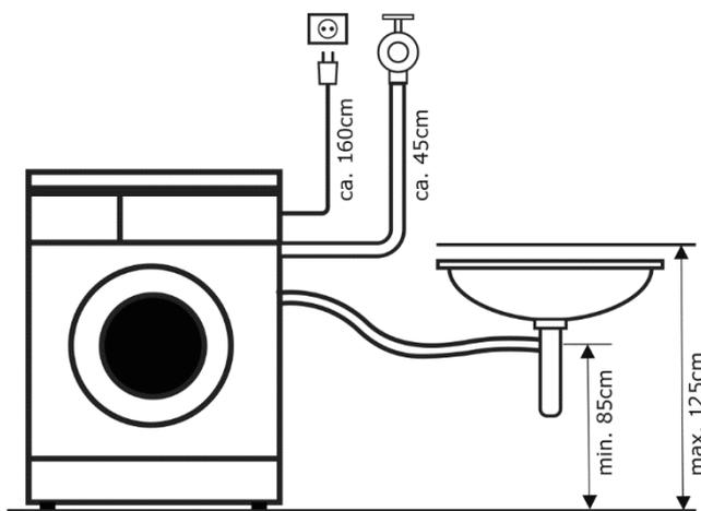
Der Anschluss an den Wasserhahn erfolgt mit dem vom Hersteller gelieferten Schlauch. Das geknickte Ende an der Rückseite des Gerätes und das gerade Teil am Wasserhahn anschließen.
