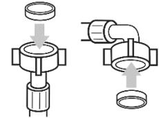
In den Anschlüssen beider Rohrenden befinden sich zwei Dichtungen, um das Austreten von Wasser zu verhindern.
