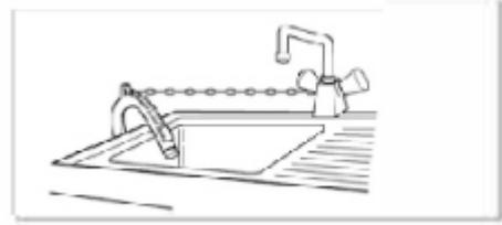
Ist die Waschmaschine an ein eingebautes Abpumpsystem angeschlossen, prüfen Sie, ob letzteres mit einem Lüftungsloch ausgestattet ist, um ein gleichzeitiges Zulaufen und Abpumpen von Wasser (Siphon – Effekt) zu vermeiden
