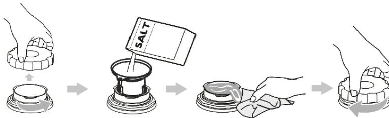
1. Unterkorb entfernen, Deckel des Salzbehälters abschrauben.
