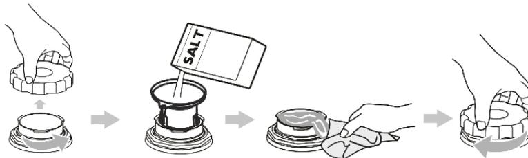
1. Unterkorb entfernen, Deckel des Salzbehälters abschrauben.
